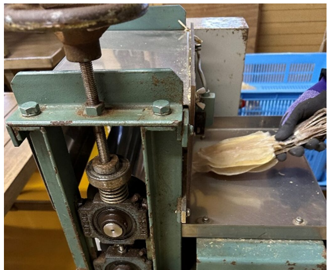
写真9 ロール機で伸展・整形している様子
